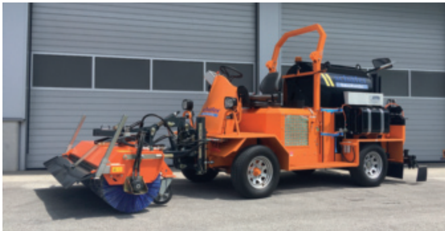
Der SKS-Kantenspritzkocher ermöglicht die exakt dosierte Bearbeitung von Mittelnähten, Rand- und Kantenversiegelung.
