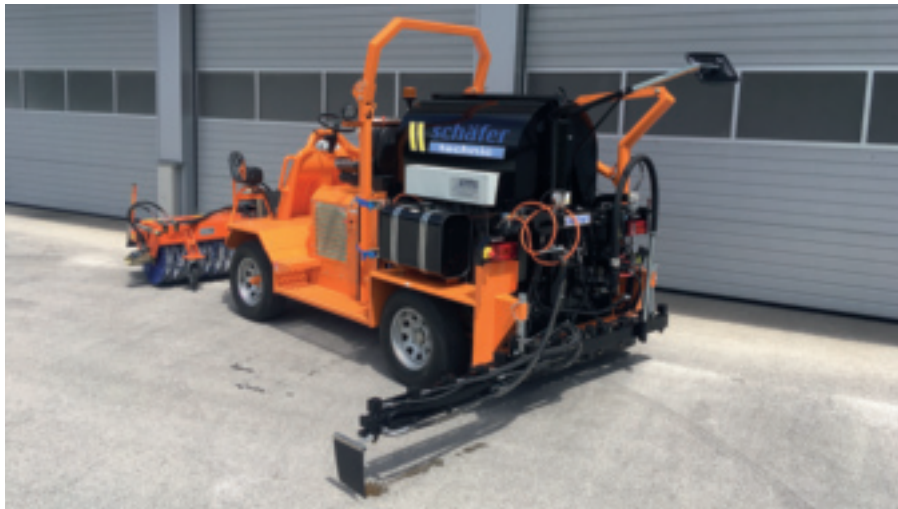
Mit ausfahrbarem Balken für eine maximale Arbeitsbreite von 3 m.
