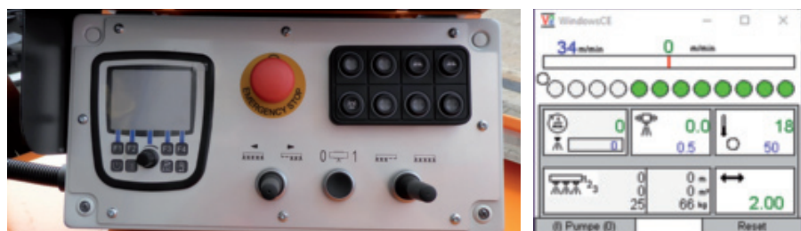
Die Maschinen-Steuerung befindet sich direkt am Fahrersitz und ist ergonomisch angeordnet. Die schäfer-technic Spray-Control (rechts) bietet eine exakte Dosierung und arbeitet automatisch mit.
