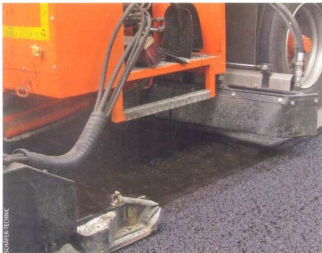
Der zum Vorspritzen erforderliche Spritzbalken ist unterhalb des Bedienstandes, hinter der letzten Achse der DSK-Maschine platziert.
