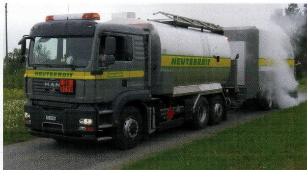
Die OB-Maschine »OB-VARIO 4300/4500« ist eine Kombinationsmaschine zur Herstellung von vorwiegend ganzflächigen Oberflächenbehandlungen. Die OB-Maschine hat im vorderen Bereich den Bindemittelbehälter mit Heizung und Pumpenaggregat, im hinteren Bereich ist der Splittbunker mit Selbstladeeinrichtung angebracht.
